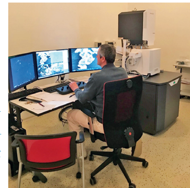
Obr. 2 – Vysoce rozlišující skenovací mikroskop Apreo (Thermo Fischer Scientific), který je vybaven pro 3D rekonstrukce systémem VolumeScope, je instalován v Laboratoři elektronové mikroskopie, Biologické centrum AV ČR, České Budějovice.
